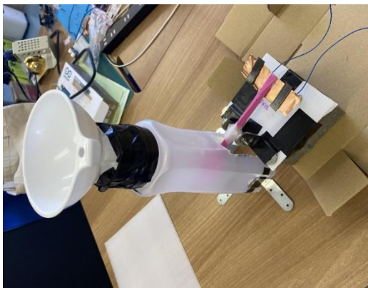
図 14 雨量計の外観。ピンク色のスプーンが鹿威しの竹筒の役割をしている。
